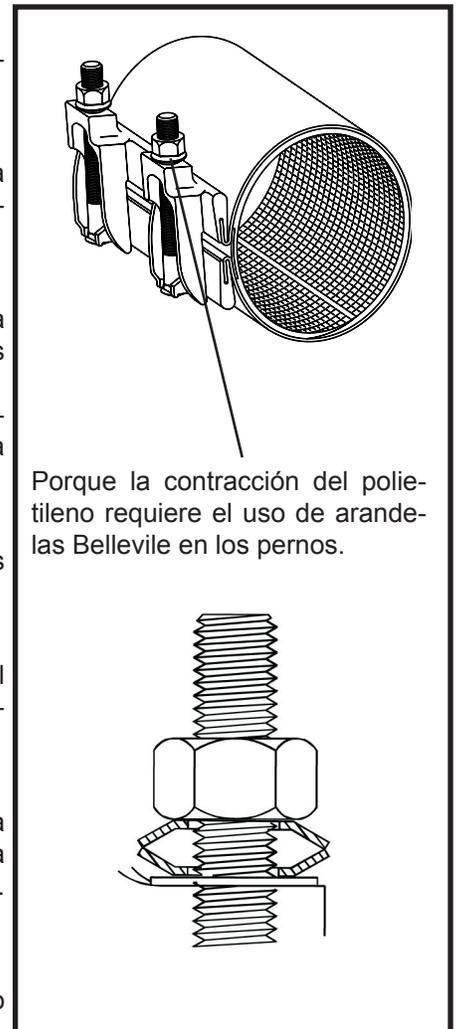
Porque la contracción del polietileno requiere el uso de arandelas Belleville en los pernos.
