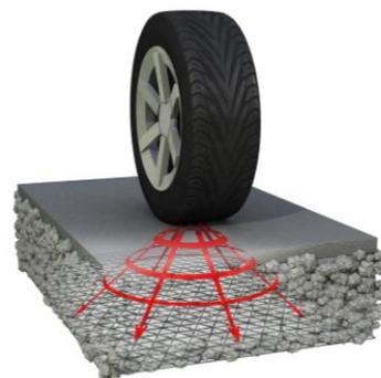
Figure 2 - Répartition de la charge avec une géogrille triaxiale
