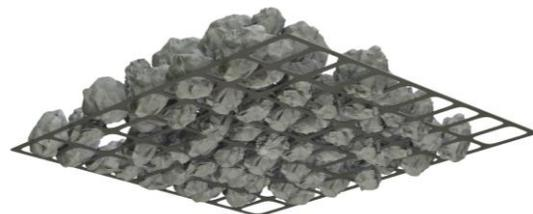
Figure 1 - Représentation d'une géogrille biaxiale
