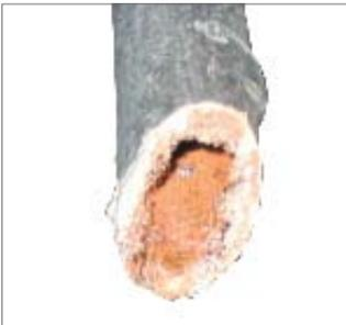
Accumulation de corrosion dans les tuyaux en métal
